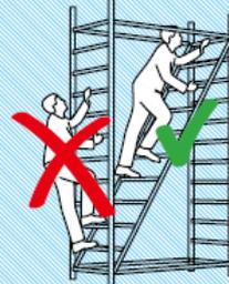
→ Nacelle : monter et descendre uniquement lorsque la nacelle est en bas
